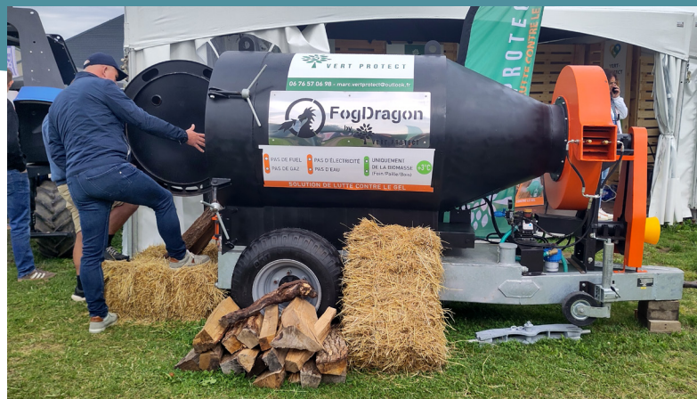
Système FogDragon® (Vert Protect) : générateur mobile de chaleur et de brouillard thermique à base de biomasse. Il crée un voile isolant combinant chaleur et fumée.
