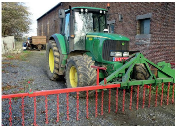
La poutre métallique est repliable et, dépliée, elle doit **couvrir la largeur de travail de la faucheuse**. En fonction de la robustesse du système, un contre-poids peut être ajouté à l'opposé de la partie dépliable de la barre. Un ressort de sécurité peut aussi être fixé à la base de la partie dépliable.
